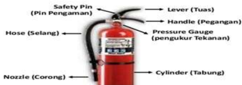
Gambar : bagian-bagian APAR
